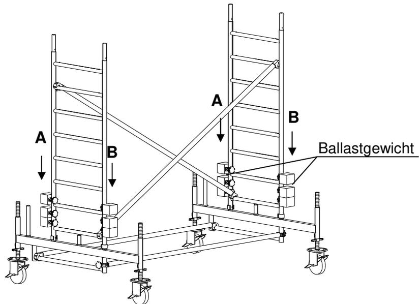
**Bild 7:** Grundeinheit mit Fahrbalken L180 und Ballast
