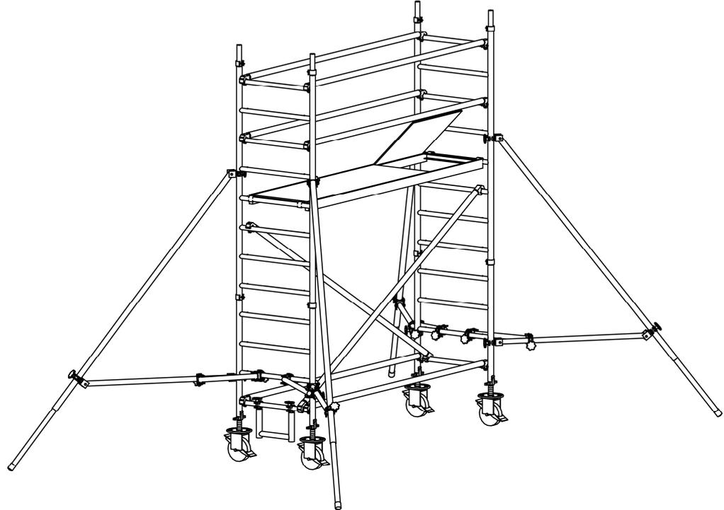
**Bild 15:** Aufbau mit Alu-Gerüststütze, Standhöhe 2.25 m
