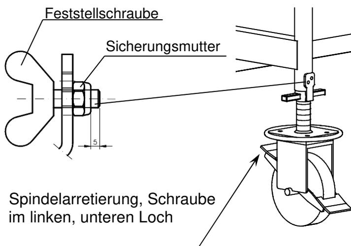
**Detail:** Spindelarretierung, Schraube im linken, unteren Loch
