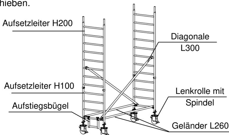
**Bild 13:** Grundeinheit ohne Fahrbalken, Standhöhen wie oben
