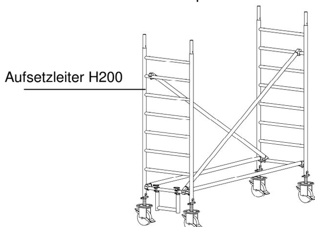
**Bild 14:** Grundeinheit ohne Fahrbalken, Standhöhen wie oben
