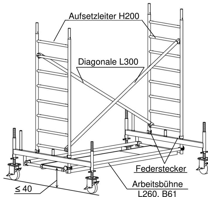
**Bild 4:** Grundeinheit mit Fahrbalken L180 – mittige Stellung
