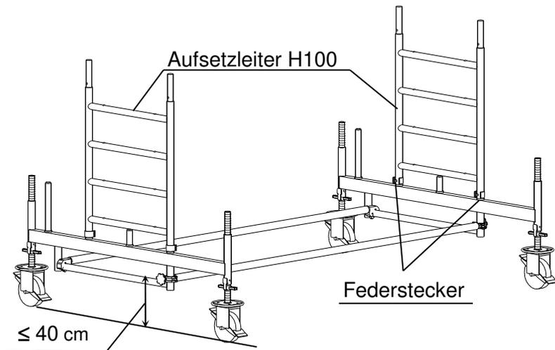
**Bild 3:** Grundeinheit mit Fahrbalken L180 – mittige Stellung
