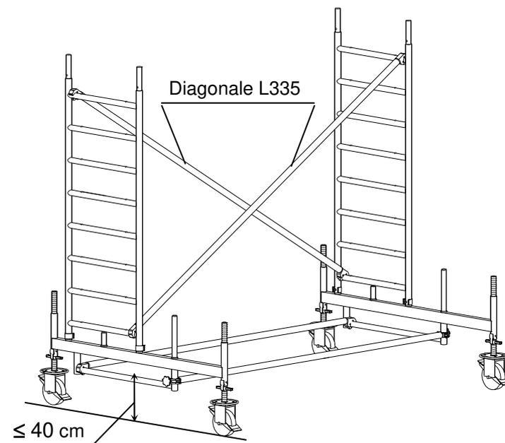
**Bild 5:** Grundeinheit mit Fahrbalken L180 – wandseitige Stellung
