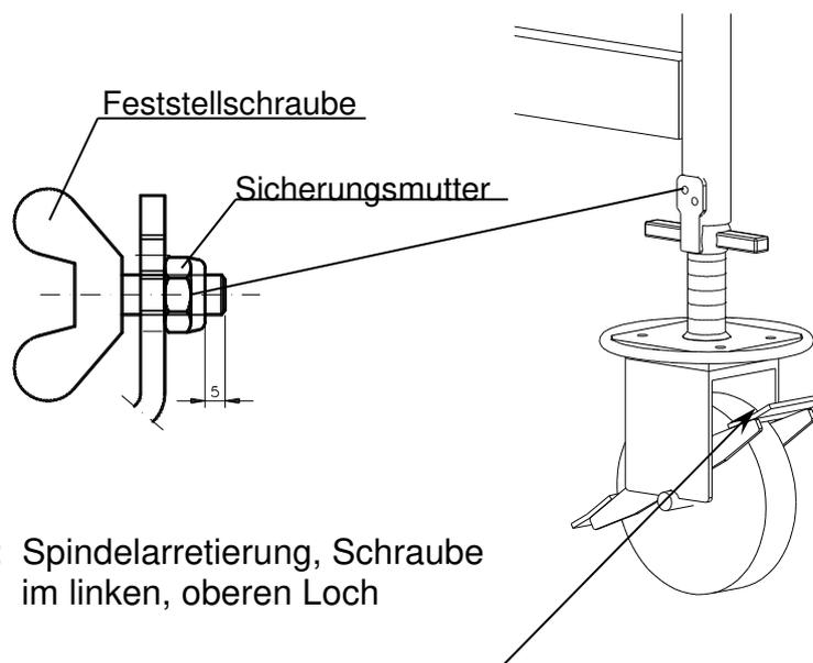
**Detail:** Spindelarretierung, Schraube
