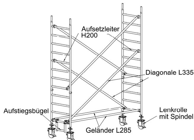
**Bild 13:** Grundeinheit ohne Fahrbalken, Standhöhen wie oben
