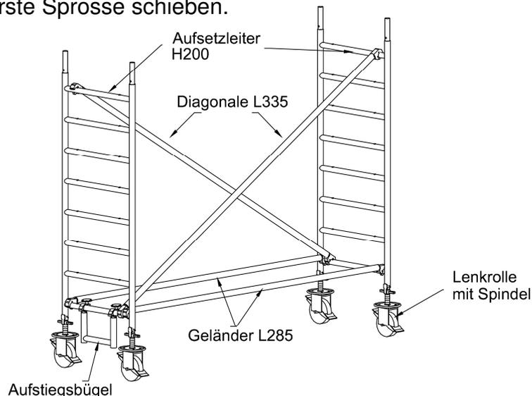
**Bild 14:** Grundeinheit ohne Fahrbalken, Standhöhen wie oben
