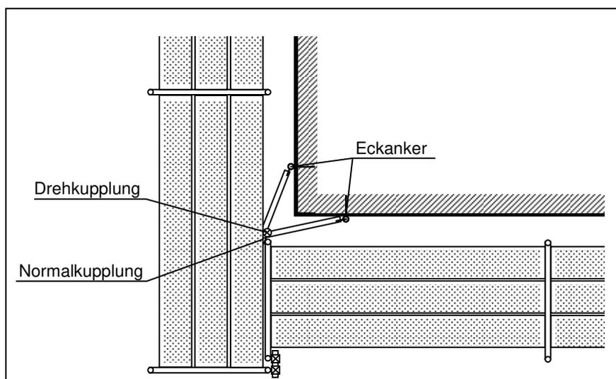
**Bild 19:** Zusätzliche Verankerung im Eckbereich
