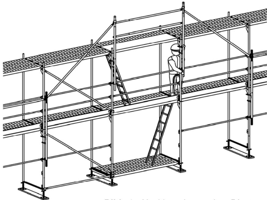
**Bild 12:** Hochbau des zweiten Pfostens
