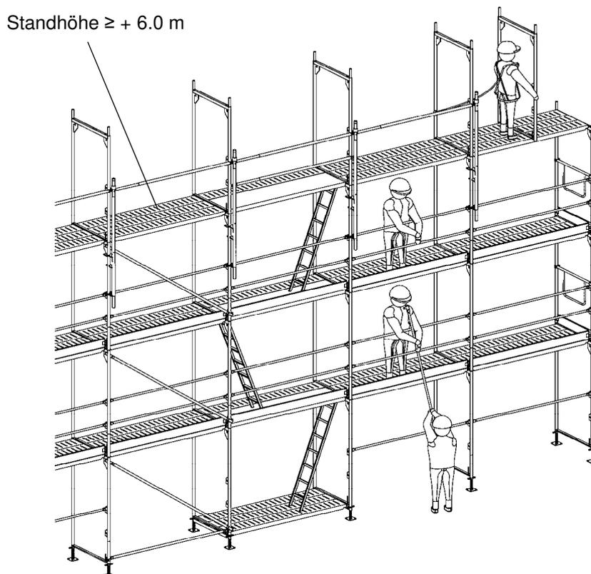
**Bild 16:** Aufbau im Schutze von PSAgA
