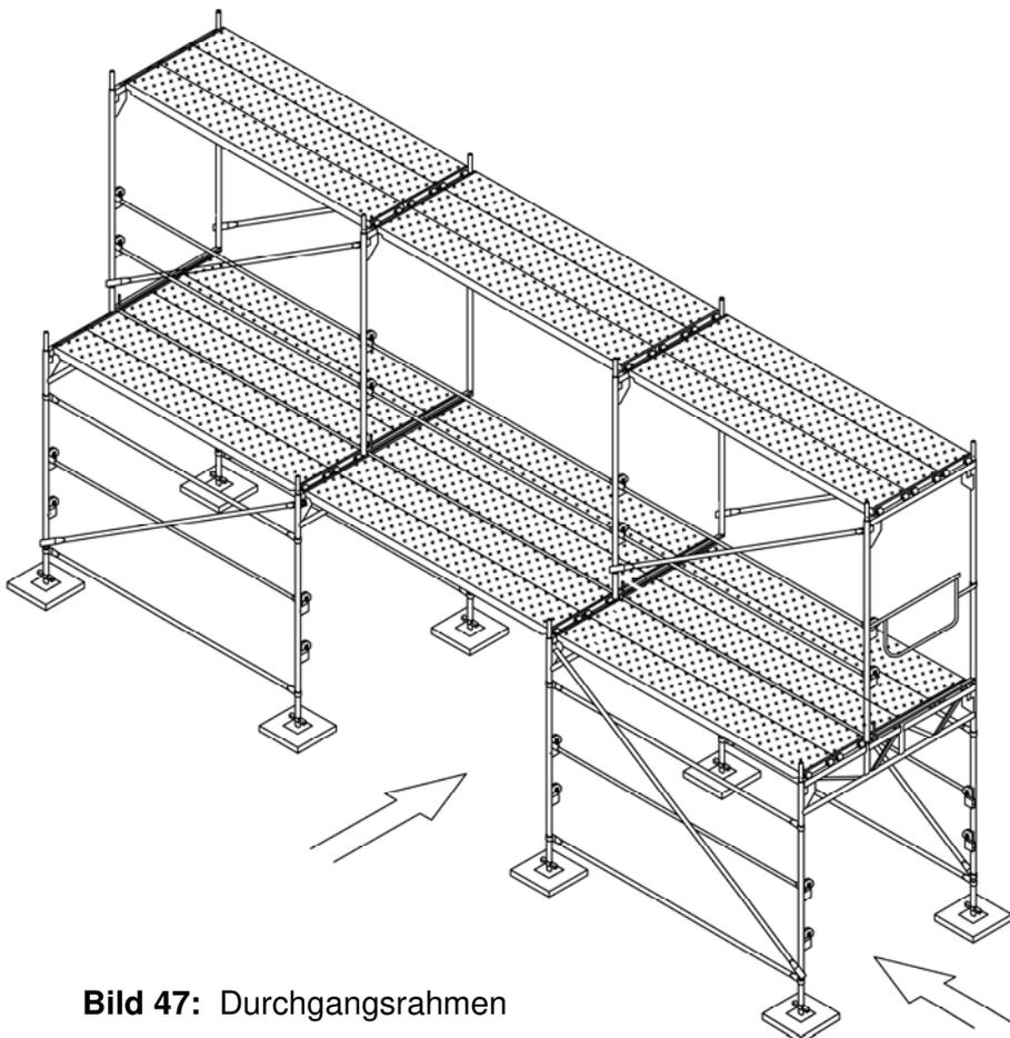
**Bild 47:** Durchgangsrahmen
