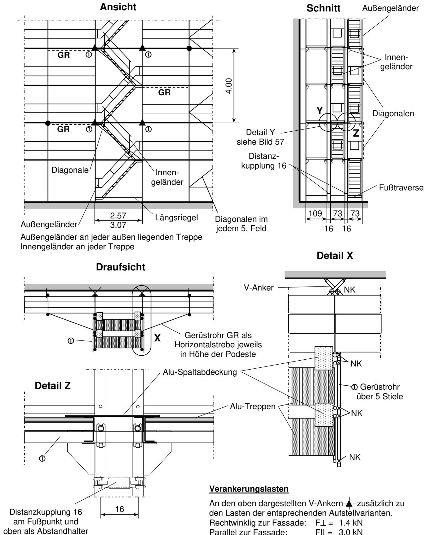
**Bild 59:** Oberer Abschluss gleichläufige Treppe
