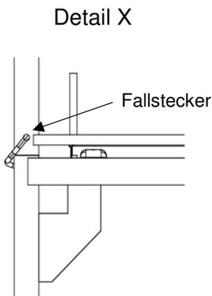
Die Beläge werden durch den unteren Querriegel des darüber liegenden Rahmens gegen Ausheben gesichert. In der obersten Etage wird dies vom Querschenkel der Geländerstütze oder der Schutzgitterstütze übernommen. Bei Einsatz des einfachen Geländerpfostens ist die obere Belagsicherung einzubauen. Konsolen, Durchgangsrahmen und Schutzdach sind mit speziellen Abhebesicherungen versehen.
