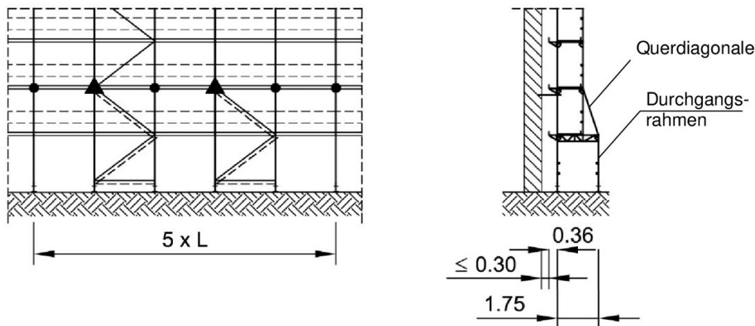
Spindelhöhen, Aussteifung und sonstige Verankerung wie bei den Ausführungen ohne Durchgangsrahmen.
