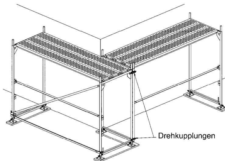
**Bild 6:** Eckausbildung mit Drehkupplungen (Gerüst nur teilweise dargestellt)
