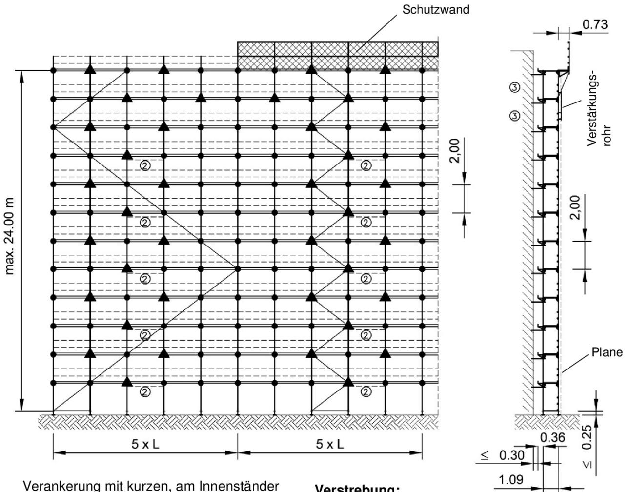
● Verankerung mit kurzen, am Innenständer befestigten Gerüsthaltern.
