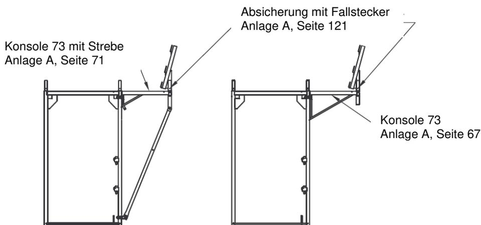
**Bild 24:** Schutzdachadapter
