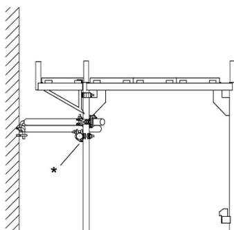
\* Gerüstrohr Ø 48.3 mit Normalkupplungen an den Innenständern angeschlossen. (alternativ: Längsriegel, Anlage A, Seite 21)
