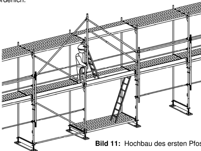
**Bild 11:** Hochbau des ersten Pfostens
