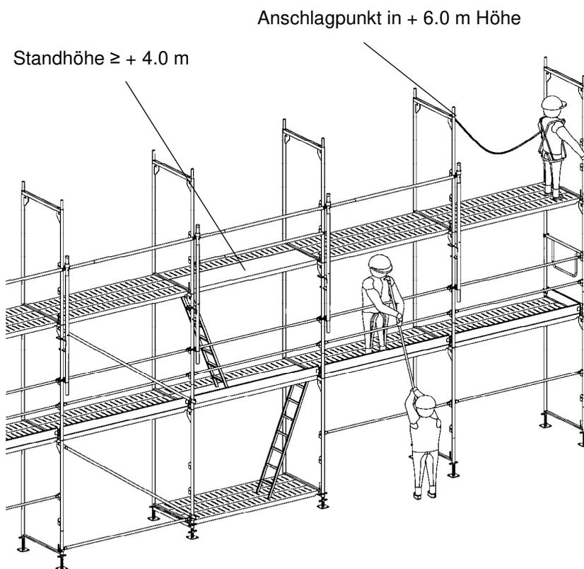
**Bild 15:** Aufstecken der weiteren Vertikalrahmen
