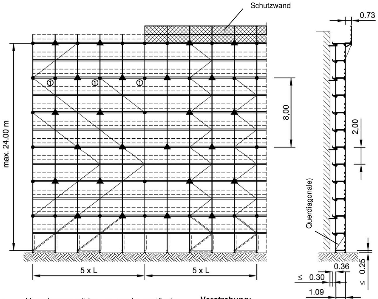
Verankerung mit kurzen, am Innenständer befestigten Gerüsthaltern.
