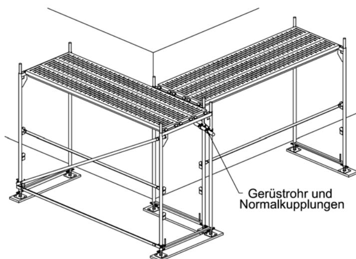
**Bild 7:** Eckausbildung mit Gerüstrohren und Normkupplungen (Gerüst nur teilweise dargestellt)
