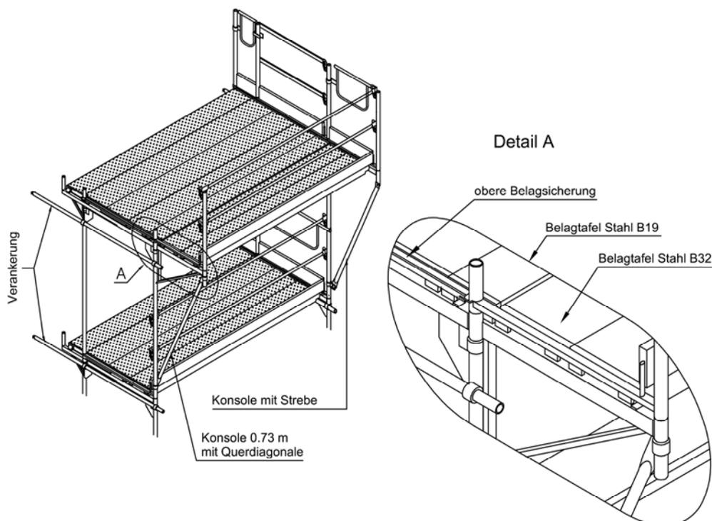
**Bild 21:** Verbreiterung der obersten Ebene mit Konsolen 36 und 73
