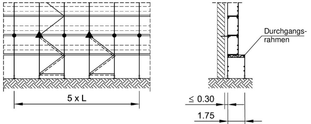
Spindelhöhen, Aussteifung und sonstige Verankerung wie bei den Ausführungen ohne Durchgangsrahmen.
