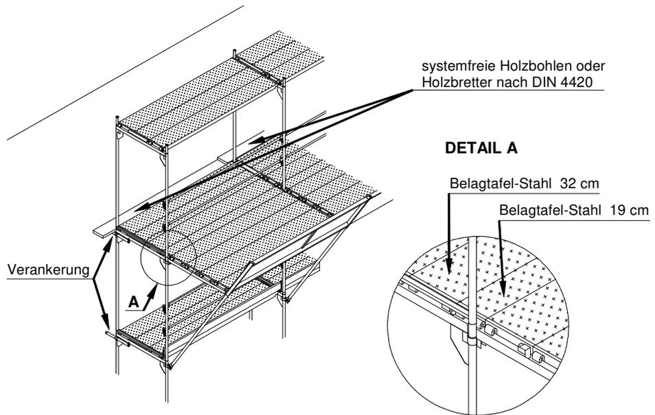
**Bild 23:** Schutzdachkonsole
