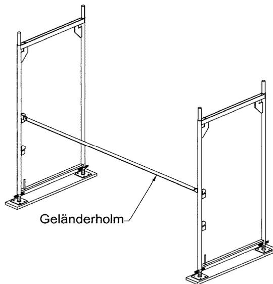
**Bild 4:** Aufbau des ersten Gerüstfeldes
