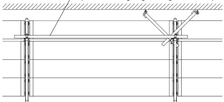
**Bild 20.2: V-Anker mit Gerüstrohraussteifung**
