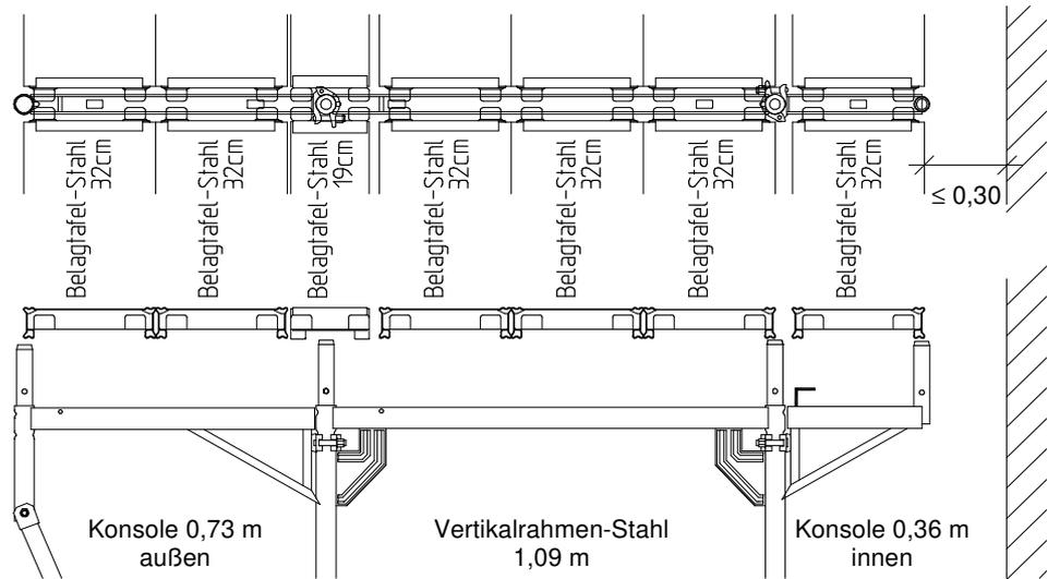
**Bild 22:** Anordnung der Beläge bei Gerüstverbreiterungen
