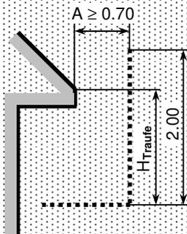
**Bild 26: Schutzwand des Dachfangerüstes**
