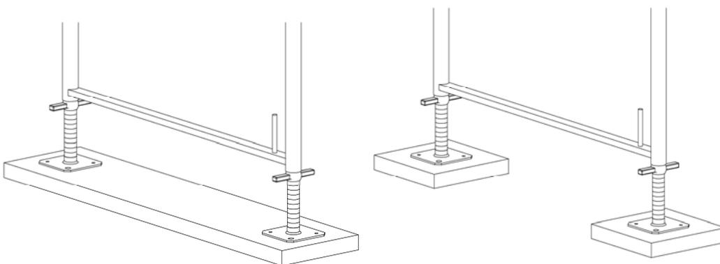
**Bild 1:** Lastverteilernder Unterbau mit Gerüstbohlen
