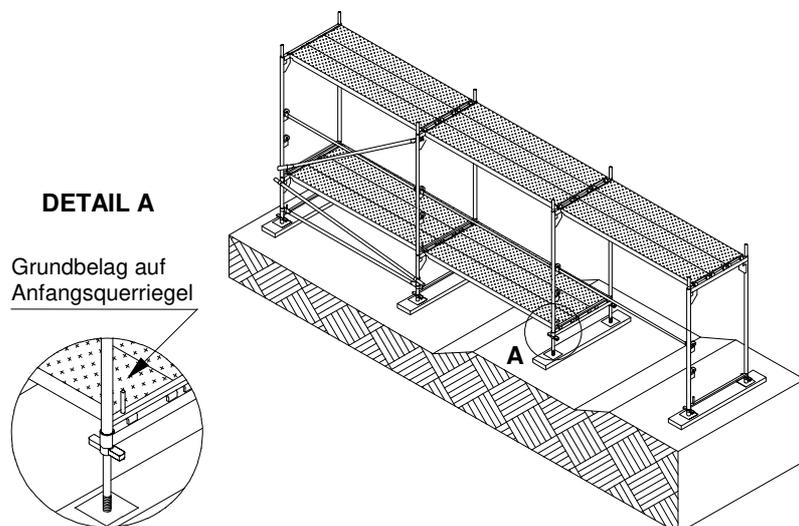
**Bild 3:** Aufbau mit Ausgleichsrahmen
