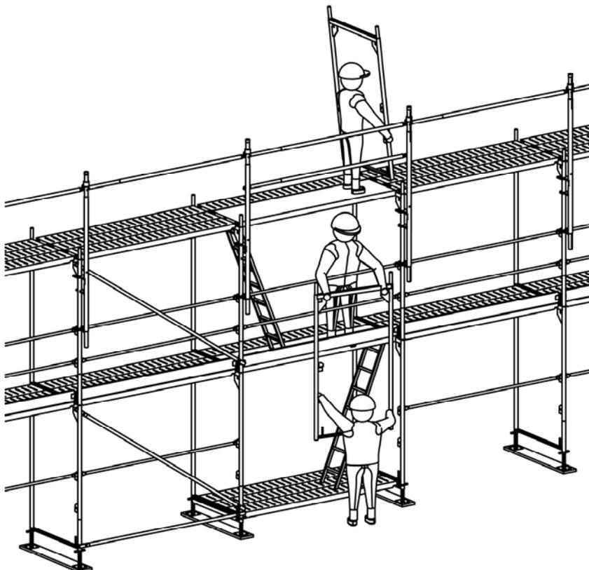
**Bild 13:** Einbau der Vertikalrahmen im Aufstiegsfeld
