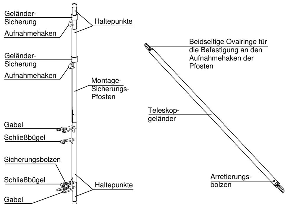
**Bild 9:** Montage-Sicherheits-Geländer
