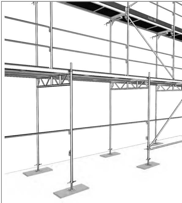
*Bild 3-1: Unterste Lage mit Durchgangsrahmen, Grundkonfiguration*
