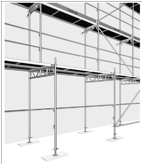
Bild 34: Unterste Lage mit Durchgangsrahmen
