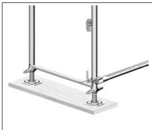
Bild 3-1: Last verteilender Unterbau mit Holzbohlen
