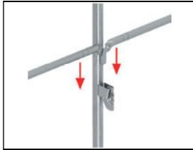
Bild 2-4: Einsetzen der Geländer
