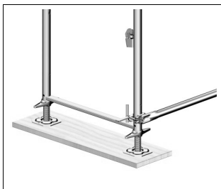
Bild 3-1: Lastverteilernder Unterbau mit Holzbohlen
