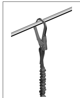
Bild 20: Detail Anschlagpunkt 4 oberer Geländerholm
