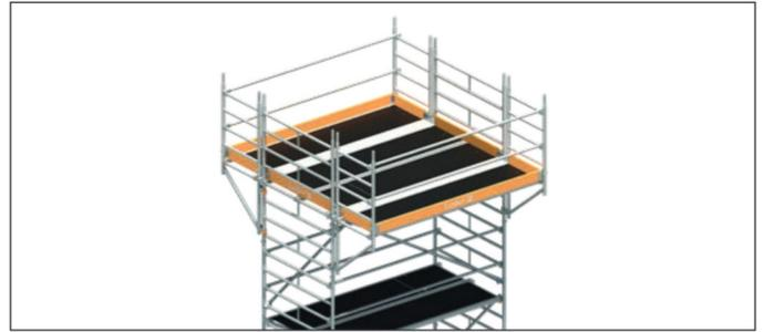
4. Nun wird die Belagbrücke 25 in die Sprossen der Konsole 0,75 m 29 eingehängt.
