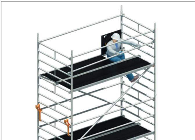
5. Innenseitiger Aufstieg über die Sprossen der Standleiter durch die dafür vorgesehene Durchstiegsklappe. In der Durchstiegsöffnung sitzend, absturzgesichert durch die Holme der Durchstiegsbrücke 24, erfolgt die Montage des Zwischengländers der nächsten Lage, hierzu werden die Geländer 14 an den zweiten Sprossen über der Standfläche montiert.
