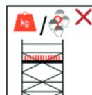
Durch die maximale Belastung der Konstruktion kann sich die maximale Anzahl von Personen, die sich gleichzeitig auf einer Arbeitsebene aufhalten dürfen begrenzen. Diese maximale Belastung durch Personen, Werkzeuge und Material auf der Arbeitsebene ist vorab zu überprüfen und wenn erforderlich zu begrenzen.
