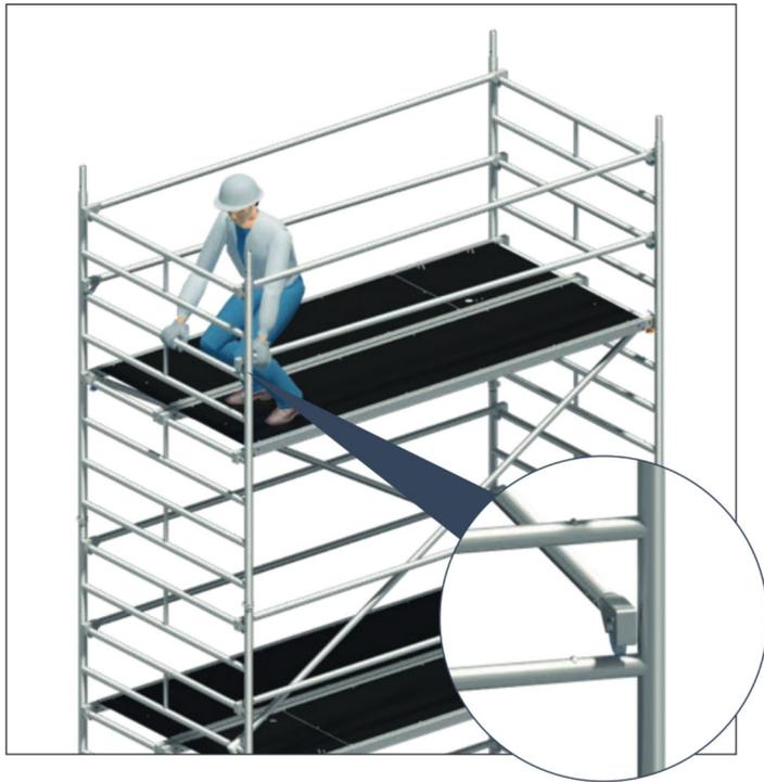
2. Einseitiges Lösen und Auflegen der Einrastklauen von beiden Zwischengeländern in 0,5m Höhe, jeweils auf der gegenüberliegenden Seite der Durchstiegsklappe.
