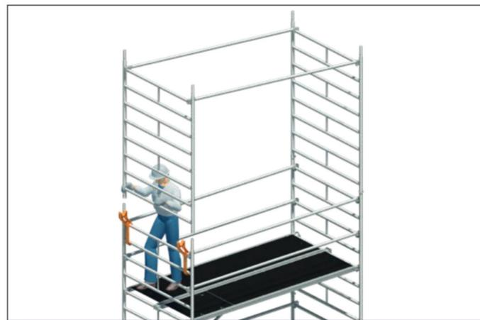
3. Standleiter mit Geländer nach oben schwenken, aufstecken und mit Federsteckern 13 sichern.
