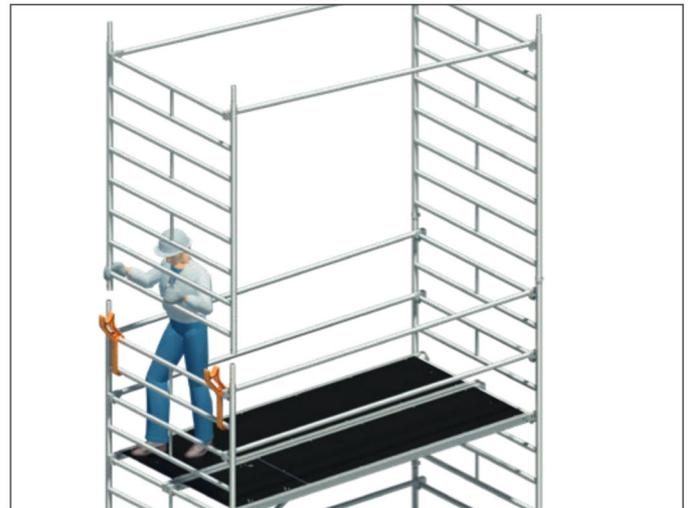
3. Diagonalen und Durchstiegsbrücke einsetzen.
