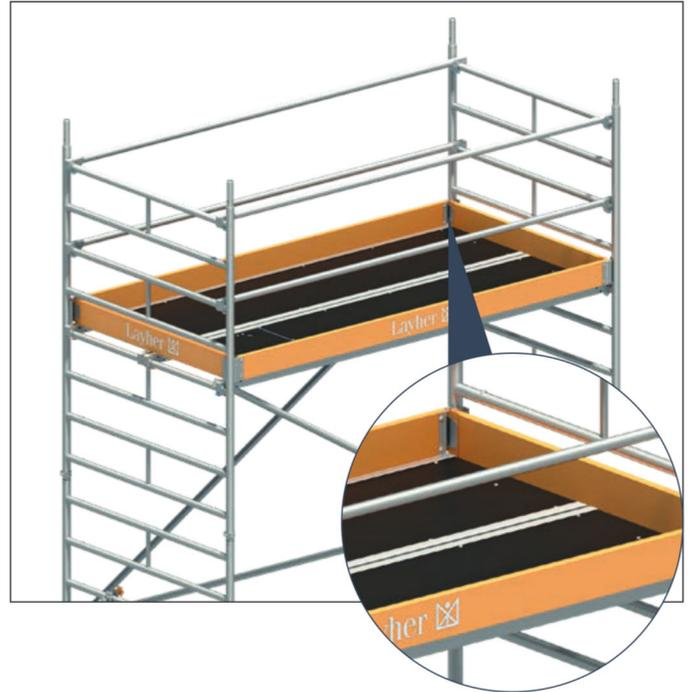
1. Zum Abschluss der Arbeitsbühne müssen Bordbretter mit Klau 27 und Stirnbordbretter 28 angebracht werden.
