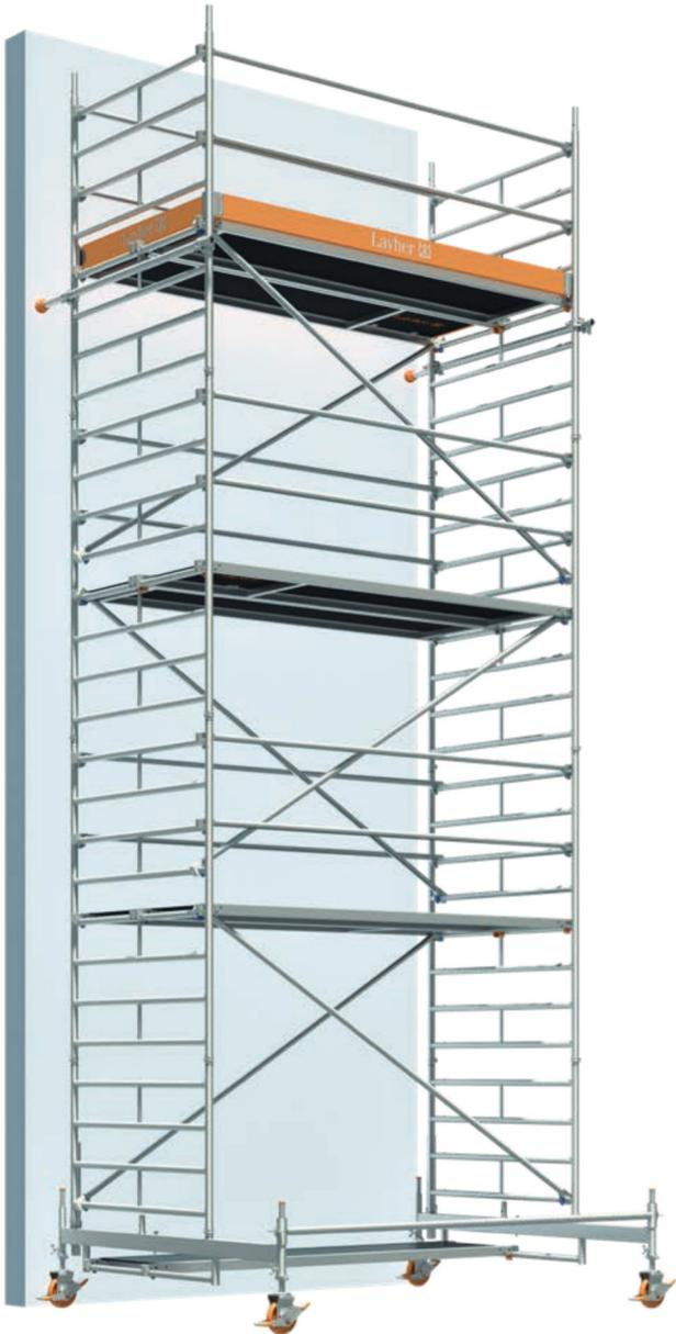
Für Arbeiten, die an einer tragfähigen Wand ausgeführt werden, kann die Ballastierung entsprechend der Tabelle **Ballastierung** (siehe Seiten 8–10) reduziert werden. In diesem Fall sind auf beiden Seiten des Gerüsts Wandabstützungen oder Verankerungen einzubauen.
