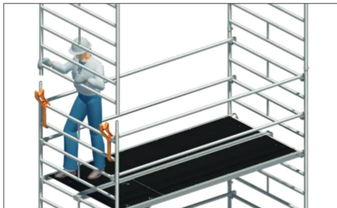
4. Durchstiegsbrücke 24 und Diagonalen 19 demontieren.
