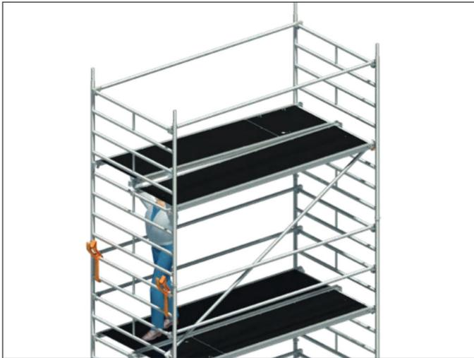
4. Diagonalen 21 und Durchstiegsbrücke 24 einsetzen. Die Diagonalen müssen auf beiden Seiten turmartig (Zick-zack-Form) eingebaut werden.
