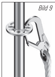
Bild 9: Anschlag im großen und kleinen Loch der Lochscheibe möglich (Nur zulässig bei AllroundGerüst aus Stahl – nicht beim AllroundGerüst aus Aluminium)
