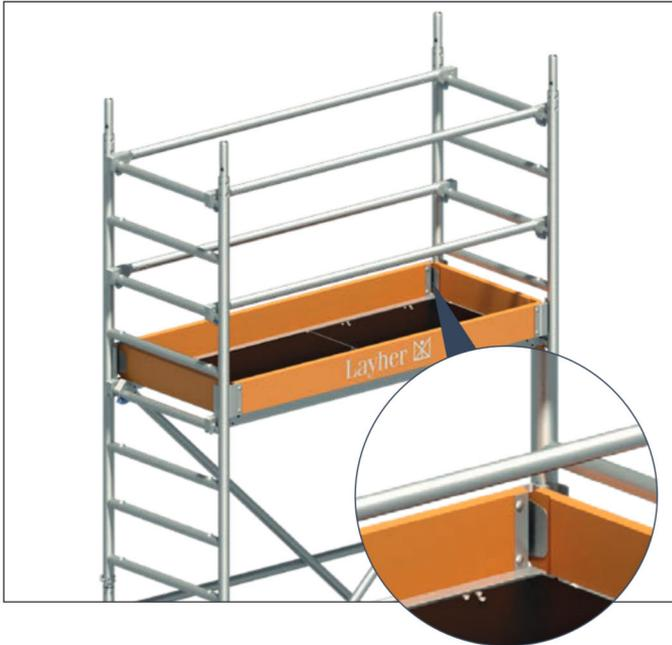
1. Zum Abschluss der Arbeitsbühne müssen Bordbretter mit Klaue [27](#) und Stirnbordbretter [28](#) angebracht werden.
