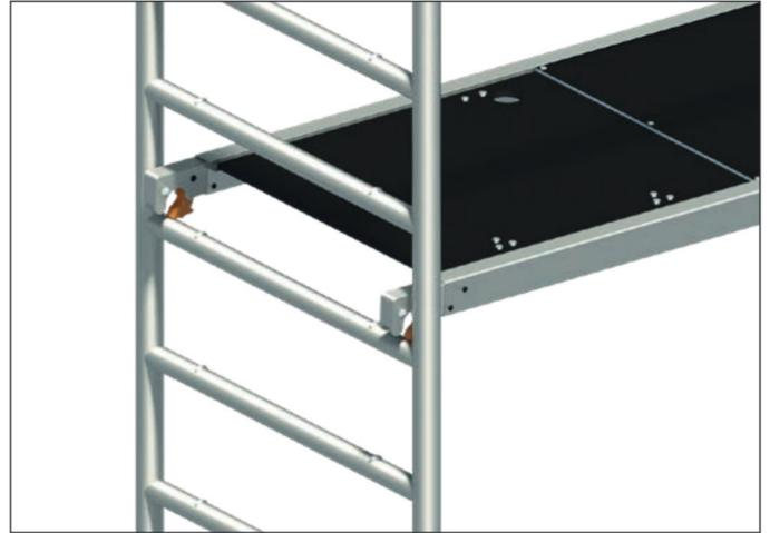
Die **orangenen** Schließbügel der Böden ermöglichen durch ihre speziell dafür gestaltete Geometrie den mühelosen Ein- und Ausbau durch eine Person; sie sind zuerst zu lösen und der Belag mit den geöffneten Bügeln auf die Sprosse aufzulegen, dann erst werden die gegenüberliegenden Bügel gelöst und der Belag ausgehoben.
