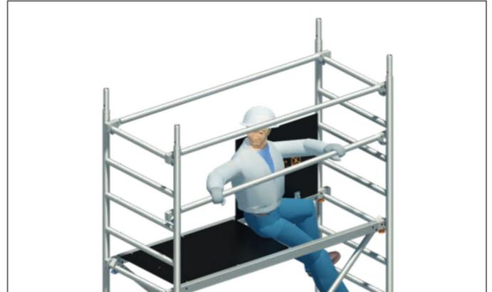
3. In der Durchstiegsöffnung sitzend, erfolgt die Demontage der Zwischengeländer, hierzu werden die bereits unter 2. einseitig gelösten und aufgelegten Geländer 18 auf der Seite der Durchstiegsklappe ausgehoben.
